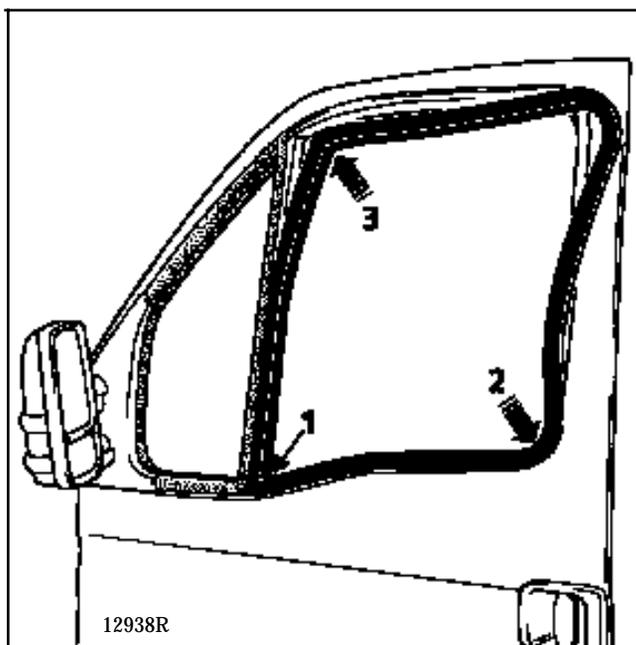
Chausser progressivement la partie avant moulée du lécheur extérieur de vitre du coin (1) vers le coin (2).
